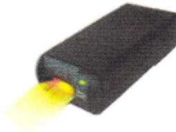
Lecteur chèque. Contient une cartouche d'encre. Il s'ouvre en tirant sur la face avant.
