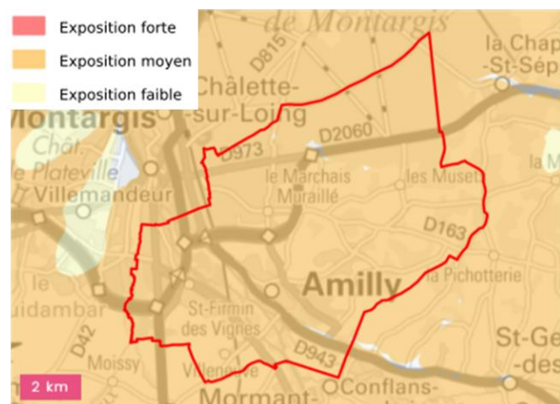
Figure 21 - Exposition de la commune d'Amilly au risque de retrait et gonflement des argiles (Géorisques)
