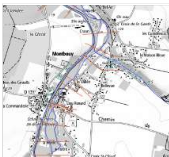
Biefs N° 6 à 8 matérialisant la submersion par remous en rive gauche du canal puis le Ru Simon affluent du Loing mais aussi l'écoulement du Loing
