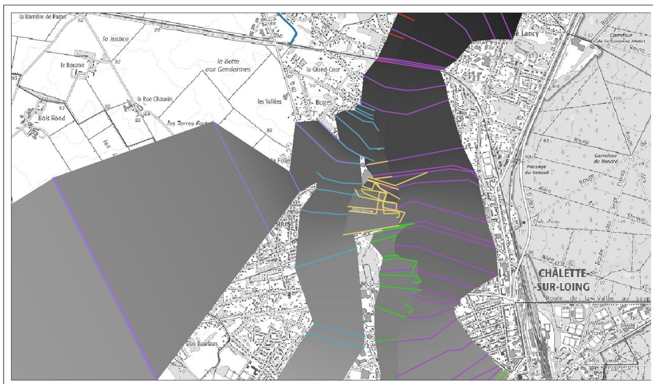
Extrait du raster MNSLE obtenu par interpolation des profils
